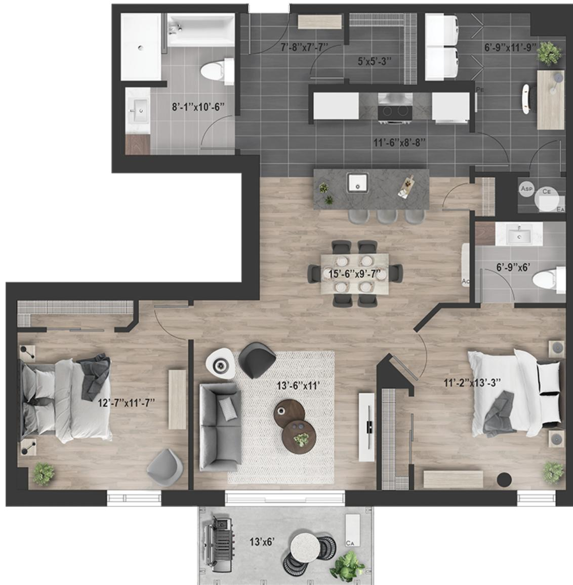
N.B. Les dimensions et superficies sont mesurées à la face intérieure des murs.
